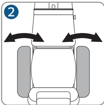
При ослаблении фиксирующего рычага на кронштейне подлокотники можно повернуть в желаемое положение по горизонтали.
